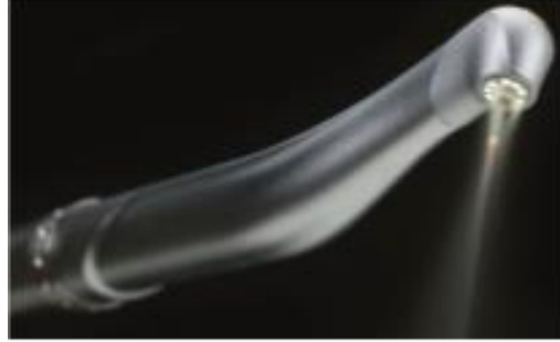
شكل 2-3 قبضة ليزر ER,Cr:YSGG مع ارذاذ هوائي مائي ( iPlus and Waterlase MD, Biolase, USA ) (Olivi )
