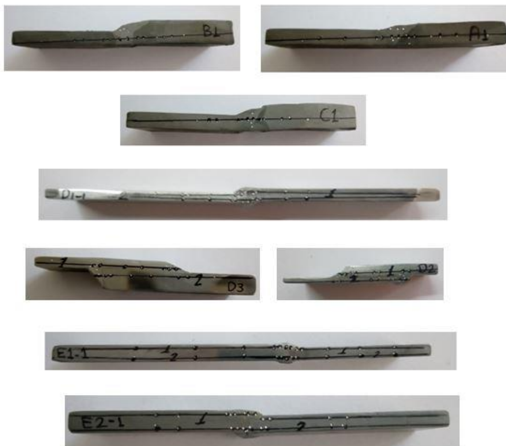
الشكل 5-11: نقاط القساوة المأخوذة على العينات الملحومة
