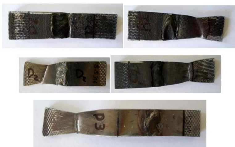
الشكل 5-14: العينات المختبرة وفق المواصفة API 1104
