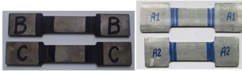
الشكل 1-4: عينات الشد المحضرة وفق المواصفة ASMI SEC IX
