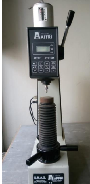
الشكل 4-12: جهاز قياس القساوة الماكروية (AFFRI) المصدر: من إعداد الباحثة
