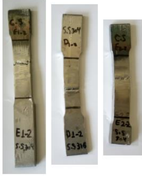
الشكل 5-15: العينات المختبرة وفق المواصفة ASMI SEC IX
