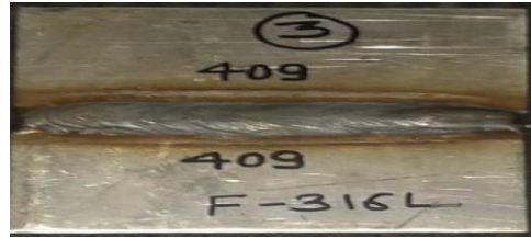
الشكل 4-1: وصلة لحامية لصفحة من AISI 409 و AISI 316L
