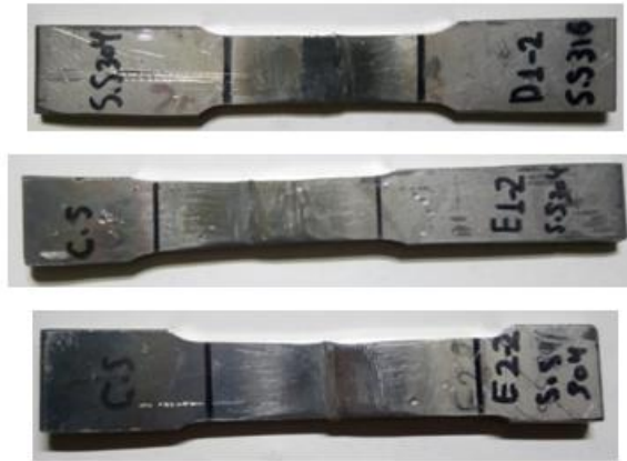
الشكل 4-34: عينات الشد المحضرة وفق المواصفة ASMI SEC IX المصدر: من إعداد الباحثة
