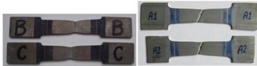
الشكل 2-4: العينات المختبرة وفق المواصفة ASMI SEC IX
