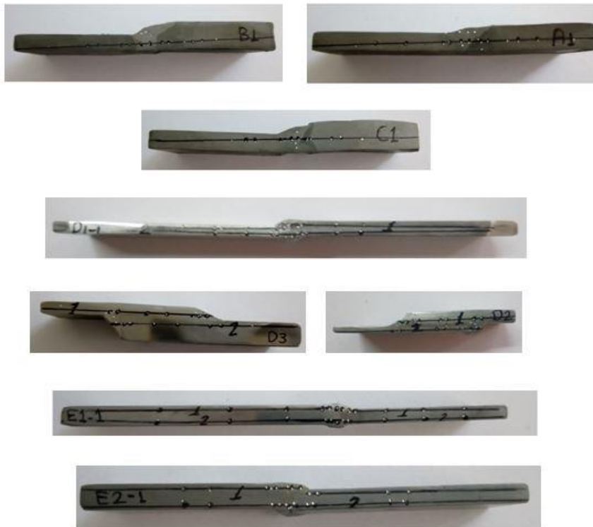
الشكل 4-31: نقاط القساوة المأخوذة على العينات الملحومة
