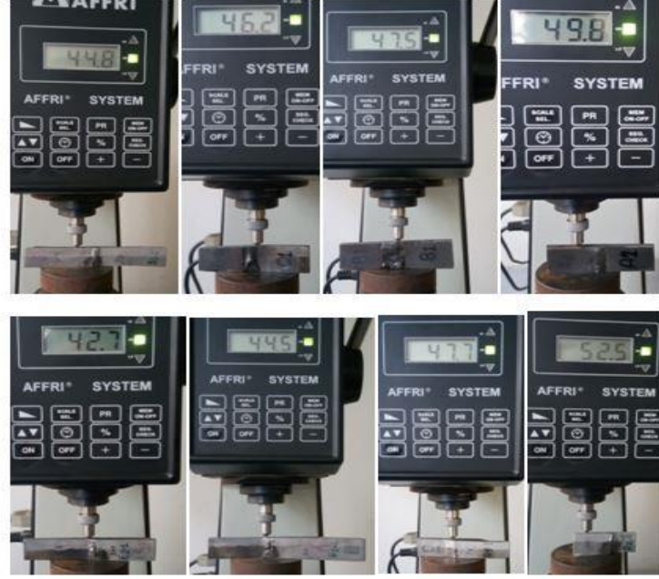
الشكل 5-12: بعض قيم القساوة موضحة على شاشة جهاز القساوة
