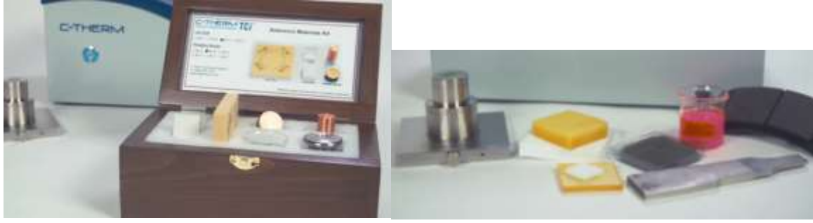
شكل يبين أجزاء الجهاز (TCI 25 C-therm)، من حساس الحرارة وأدوات اختبار السوائل والبودرة ومواد الفوم والمواد المركبة
