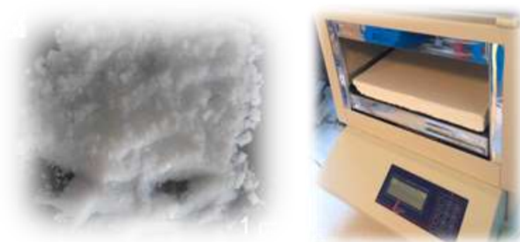
الشكل (63): يبين حبيبات السيليكا، بعد التجفيف والمعالجة بالفرن
