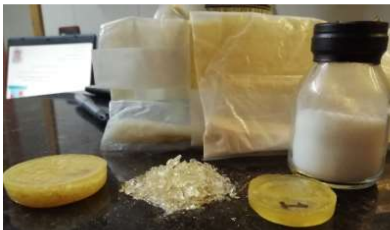
الشكل (64): يبين صور عينات المسحوق بأساس السيليكا والتي تم تحضيرها وفق تقنية النانو الـ (Sol-gel)
