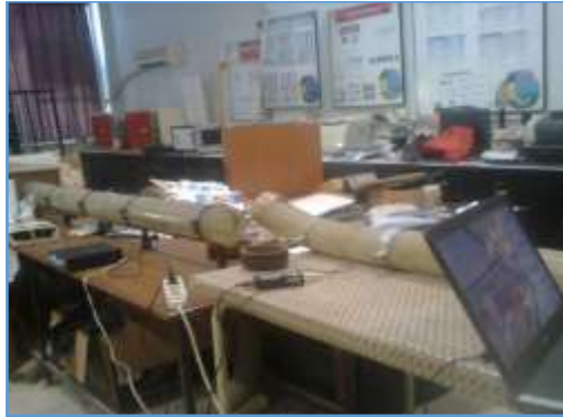
الشكل (49): أجزاء جهاز اختبار امتصاص الصوت وكفاءة العزل الصوتي، (مصطفى، 2009)
