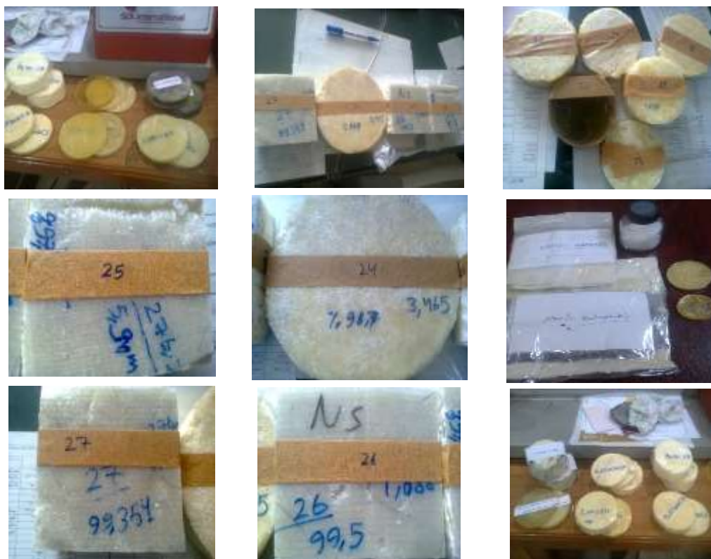
الشكل (75): صور العينات المحضرة، في هذا البحث بغرض العزل الصوتي والحراري في الأبنية
