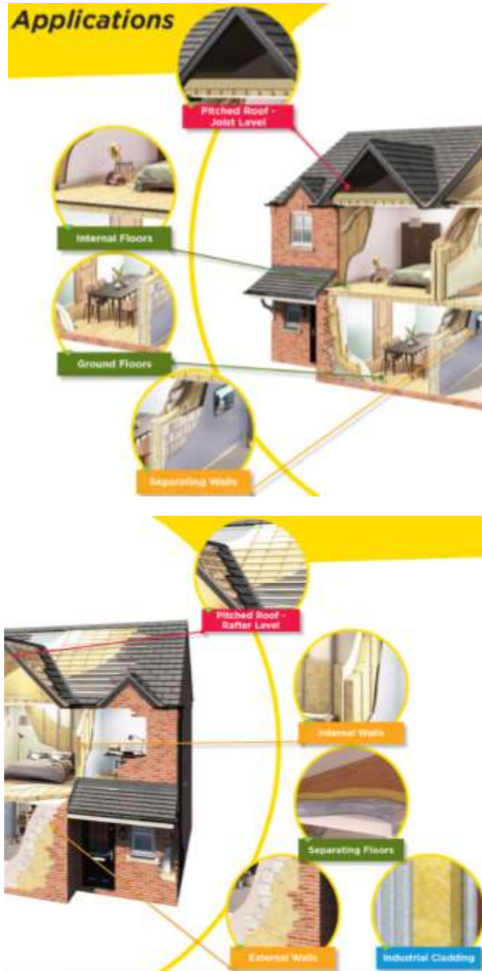
الشكل (24): يبين مناطق توضع تقانات العزل في الأبنية الحديثة، (Isover, 2019,2-3)
