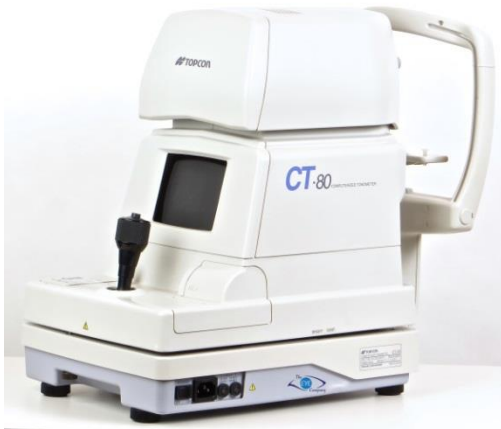
الشكل 12 المقياس الذي يعمل بآلية نفخ الهواء غير المماس (Air Puff)
