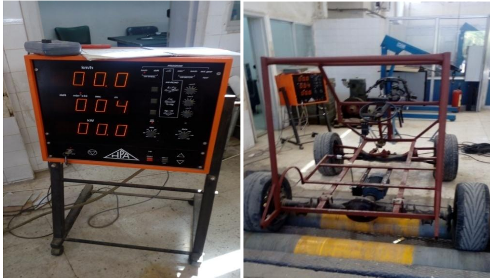
الشكل ( 1-6 ) جهاز الدينامومتر المستخدم وتوضع السيارة عليه
