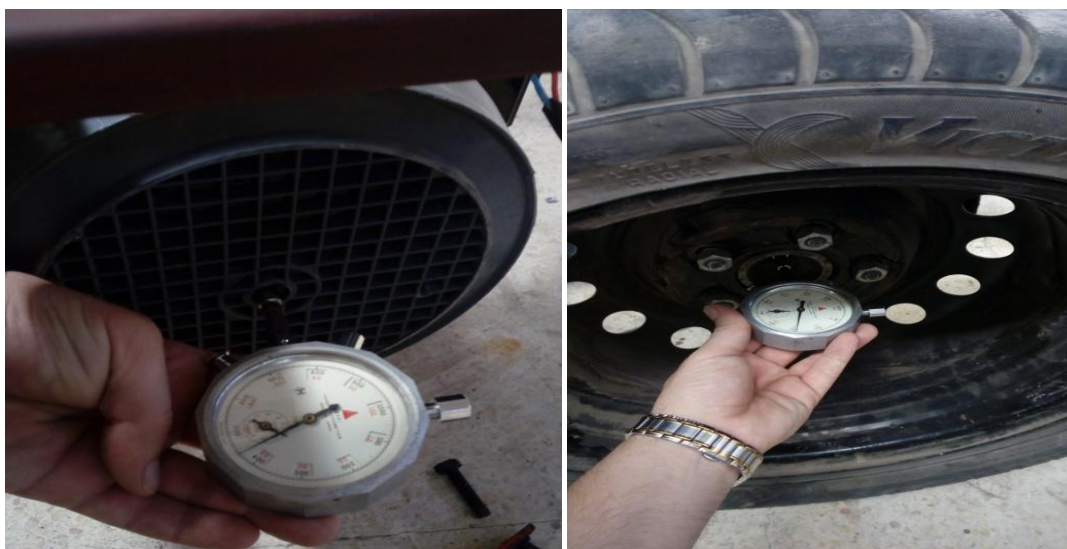
الشكل ( 3-6 ) كيفية قياس سرعة دوران العجلات والمحرك
