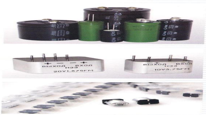
الشكل ( 6-2 ) المكثفات العادية والمكثفات فائقة السعة [6]
