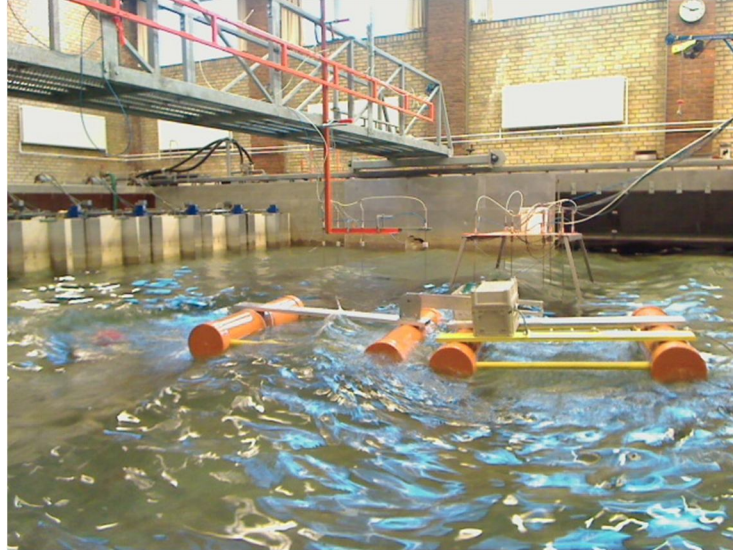
الشكل (٥ - ٤) صورة نموذج تجريبي لمبدل ديكسا في جامعة ألابورغ في الدانمارك.
