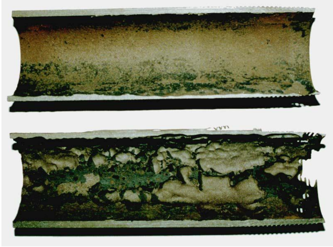
الشكل (1-20) تآكل بسبب CO_2 حيث معدل التآكل للجزء السفلي 7 mm/y [32].
