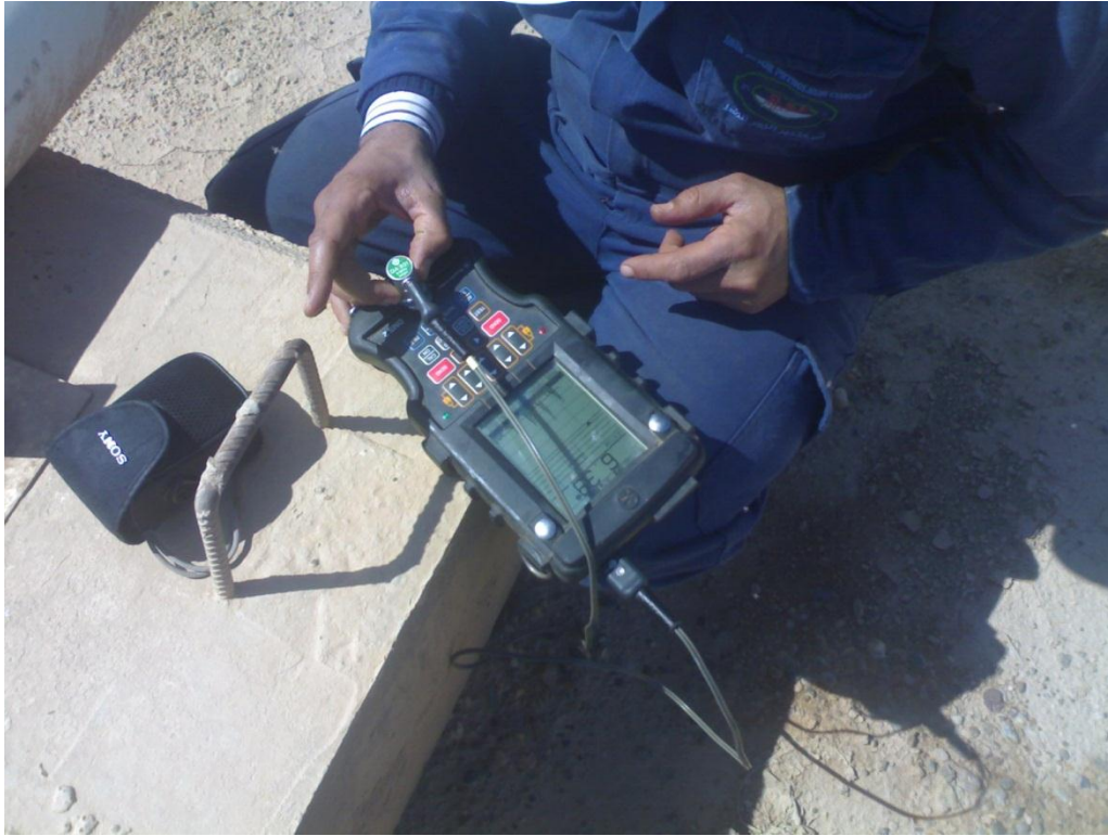
الشكل (26.3) معايرة جهاز القياس بالأمواج فوق الصوتية.
