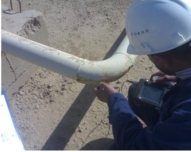
الشكل (28.3) قياس السماكة بجهاز الأمواج فوق الصوتية.
