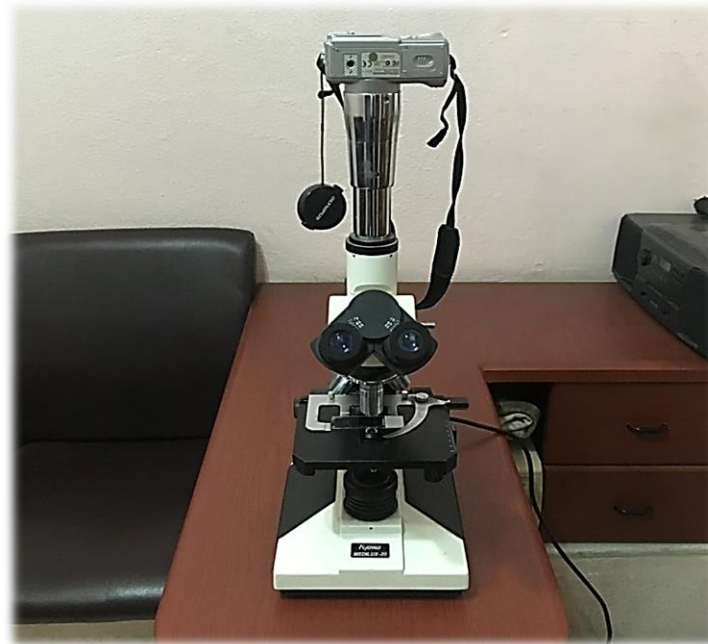
الشكل (10): المجهر الضوئي من نوع 20 MEDILUX – Kyowa مع الكاميرا من نوع Olympus
