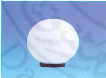
الشكل (٦٥-٢) جهاز مصباح بخار الصوديوم كتيمة جداً للإنارة التزيينية الخارجية. ناثر من الزجاج الحراري المقاوم. يركب على عمود. يغلب استخدامه لإنارة الحدائق والأروقة والشوارع الفرعية السكنية
