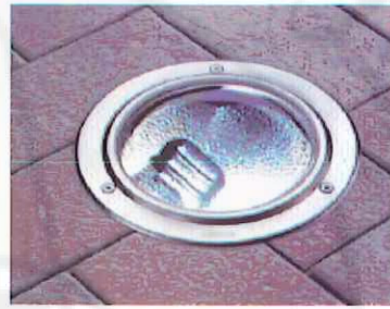
الشكل (٢-٦٢) جهاز إنارته ميتال هاليد يركب في الأسقف المستعارة. الناثر من الزجاج الحراري الشفاف والعاكس من الألمنيوم اللامع
