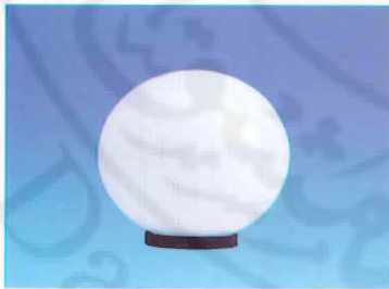
الشكل (٢-٦٥) جهاز مصباح بخار الصوديوم كتيمة جداً للإنارة التزيينية الخارجية. ناثر من الزجاج الحراري المقاوم. يركب على عمود. يغلب استخدامه لإنارة الحدائق والأروقة والشوارع الفرعية السكنية
