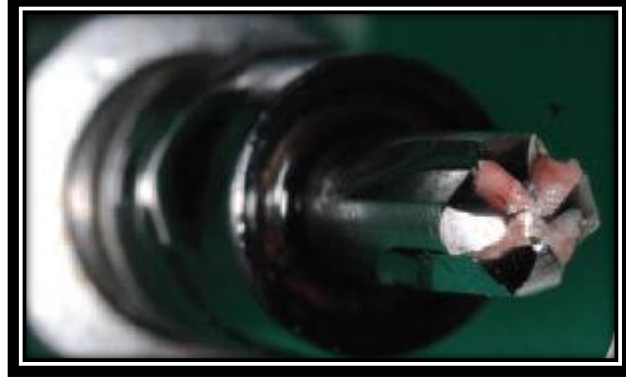
الشكل (18) الرأس المخروطي العامل للسنبله مع الرقاقة العظمية المخروطية المتشكلة من عملية الحفر
