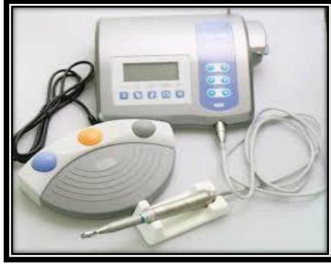
الشكل (34) موتور جراحي (Surgic XT Plus) من شركة NSK
