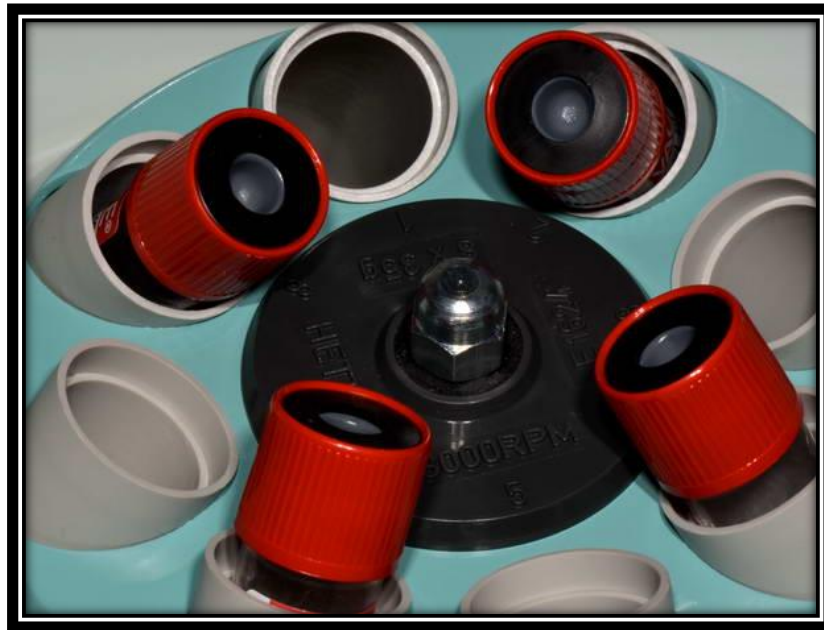
الشكل (43) يوضح كيفية توضع الأنابيب داخل المثقلة
