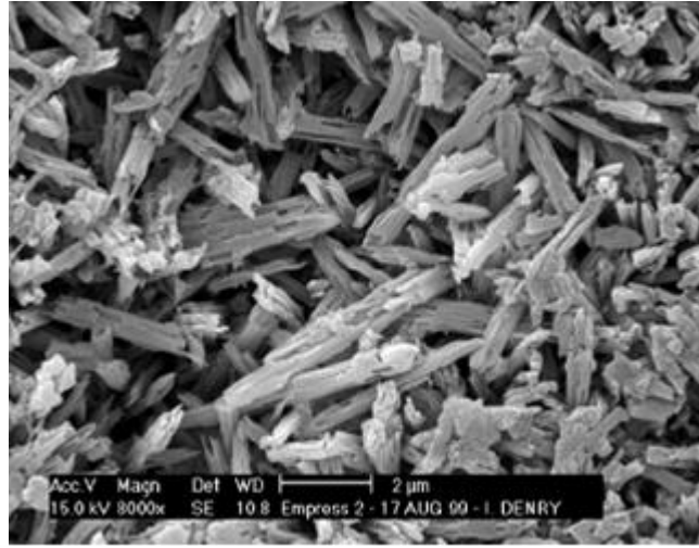
الشكل ٢ البنية البلورية للخزف المحقون المحتوي على بلورة ثنائي سيليكات الليثيوم
