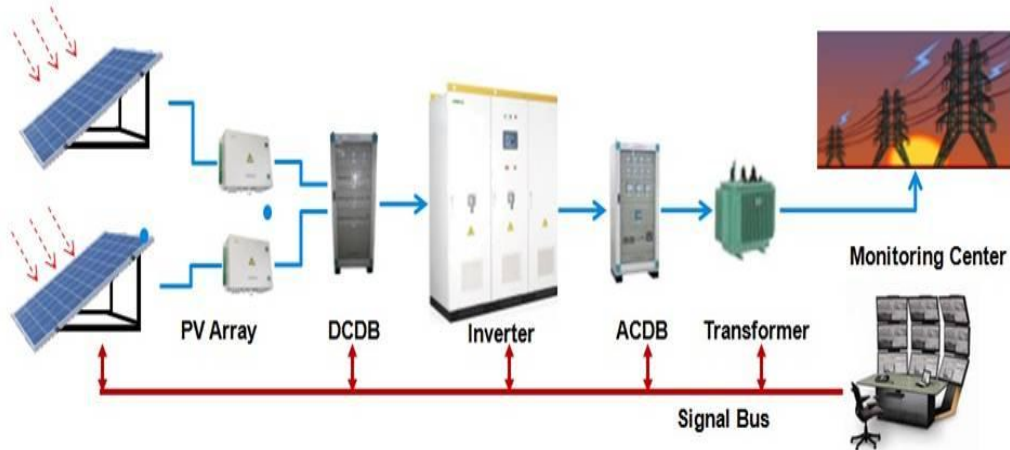
الشكل (٢٧-٢) نظام كهروضوئي مربوط مع الشبكة الكهربائية [30]
