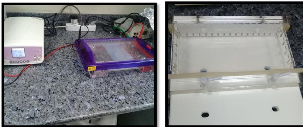
الشكل (35) A: حوض الترحيل B - جهاز ترحيل على الهلام مع وحدة التغذية Cleaver Scientific Limited
