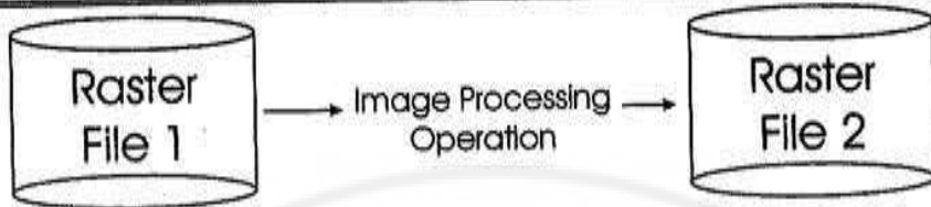
شكل (8-42) معالجة الصورة المخزنة في ملف (1) و تخزين الصورة المعالجة بملف (2) قبل إظهارها على شاشة الحاسب .
