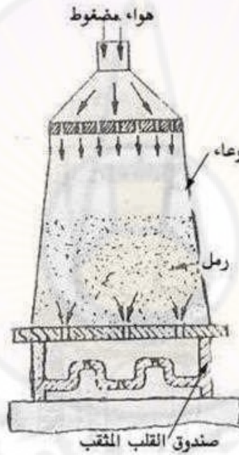
الشكل (3-7): مبدأ عمل آلة صناعة النوى بالنفخ.
