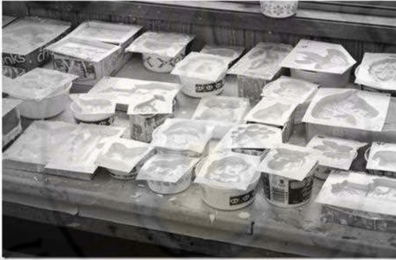
الشكل (6-6): قالب جيس جاهز ومجموعة نماذج لقوالب معدة للصب.
