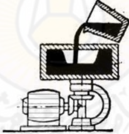
الشكل (5-9): مسبوكات شبه الدفع المركزي بقالب محمور دورانه رأسي.
