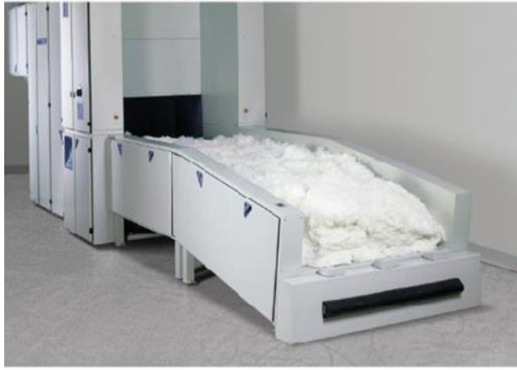
الشكل (4-8) نموذج لآلة تفتيح من إنتاج شركة تروتشلر
