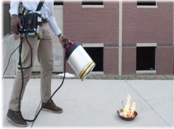
الشكل (3-9) نظام إخماد الحريق عن طريق الصوت.
