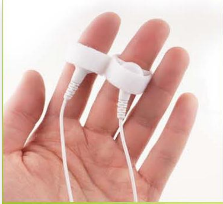
الشكل (17) قطبا جهاز الاستجابة الغلافانية للجلد
