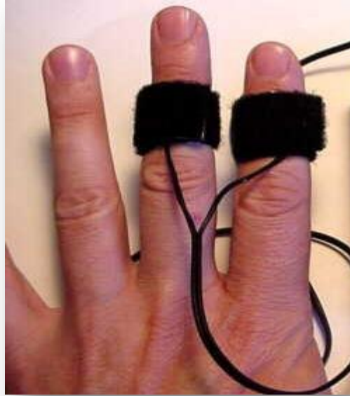
الشكل (14) موضع المستشعر عند قياس GSR
