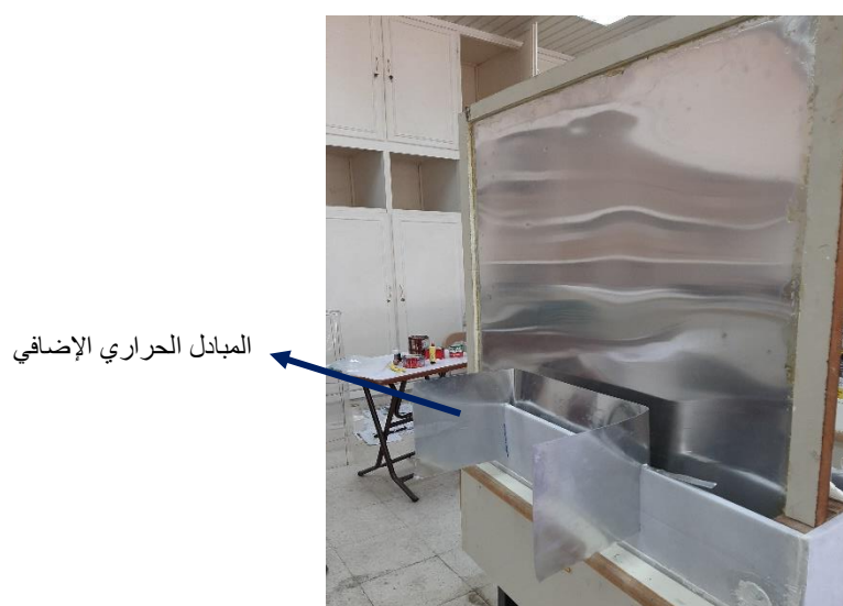
الصورة (16) صفيحة المبادل الحراري الإضافي للمكثف
