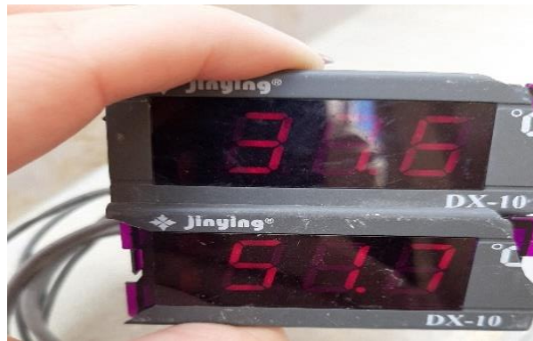
الصورة (2) ثيرموكبل لقياس درجة حرارة المقطر الشمسي العمودي الانتشاري أحادي التأثير
