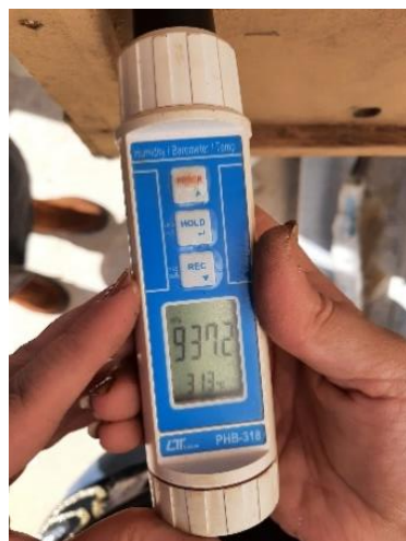
الصورة (3) مقياس درجة الحرارة والضغط داخل المقطر الشمسي العمودي الانتشاري أحادي التأثير
