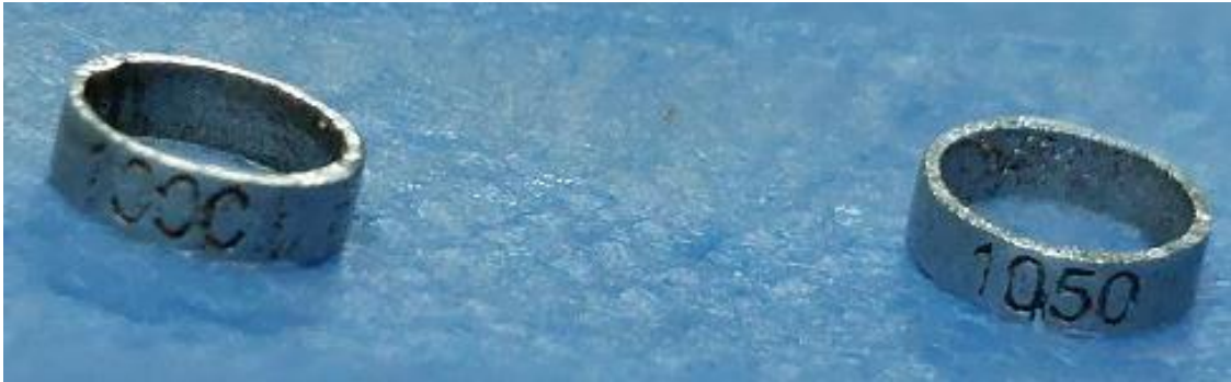
شكل (9) صورة واقعية للحلقات المستخدمة في تبديل طول ابرة الحقن
