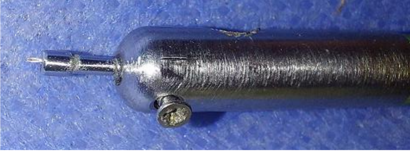
شكل (5) صورة مباشرة لحامل إبرة متبل القياس للحقن فوق مشيمية العين
