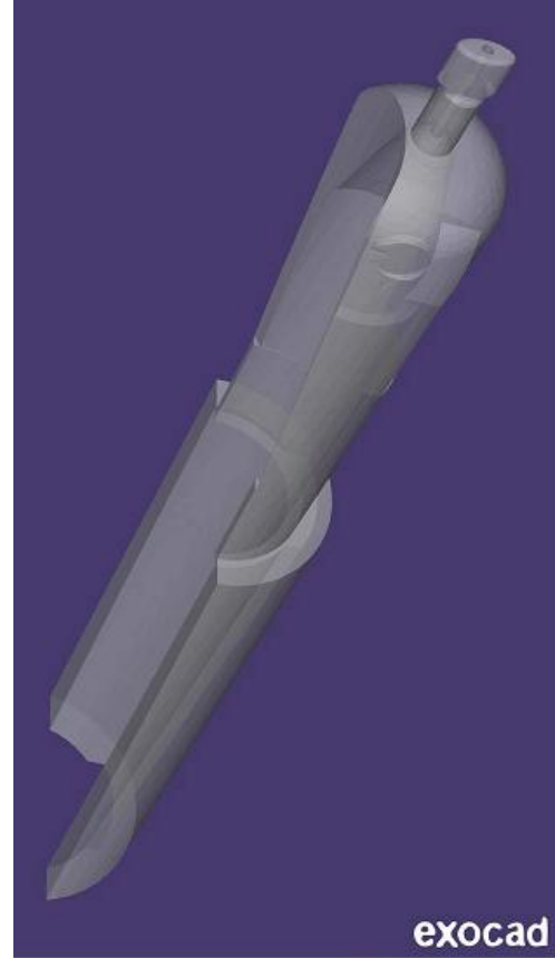
شكل (8) تصميم الأداة باستخدام برنامج EXOCAD ويوضح فيها اضافة محقن الحقن للحامل
