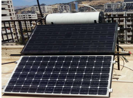
الشكل (3-5) التجربة العملية (اللاقط الكهروضوئي-اللاقط الكهروضوئي الحراري - اسطوانة الماء)
