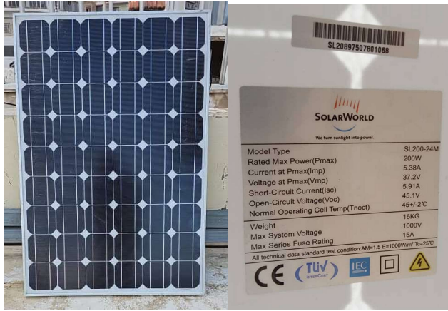
الشكل (3-6) اللوح الكهروضوئي المستخدم في التجربة
