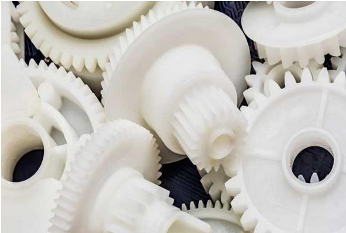
الشكل (2-1) يظهر نماذج من مسننات مصنوعة من مواد بلاستيكية
