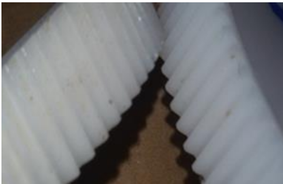
الشكل (4-5) يوضح حالة المسننات بعد نهاية المرحلة الأولى.
