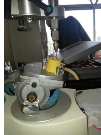
الشكل (50) تثبيت قاعدة السن على المخطط وتحقق درجة الميلان للسطح
