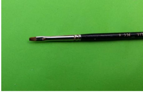
الشكل (67) فرشاة مبسطة لتطبيق المعدل اللوني مخصصة لتطبيق الخزف الظليل Opaque
