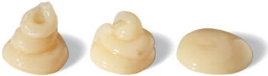
شكل (2) لزوجات الإسمنت الراتنجي اللاصق II Variolink المختلفة
