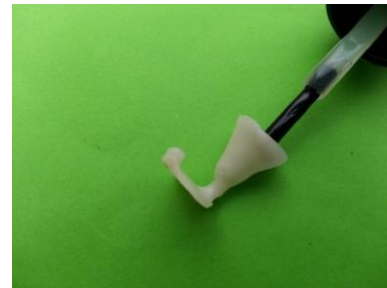
الشكل (54) النموذج الشمعي للقالب الخزفي
