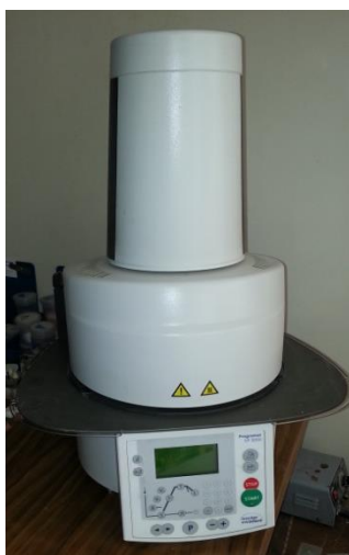
الشكل (9) فرن لحقن الخزف Programat EP 3000
