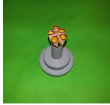
الشكل (88) توتيد التيجان الشمعية
