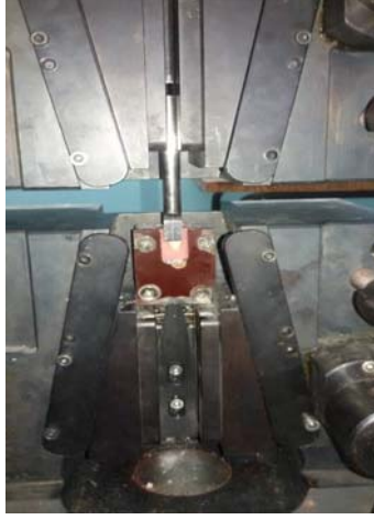
شكل (23): إحدى عينات البحث ضمن طاولة عمل الجهاز مع شفرة تطبيق القوى
