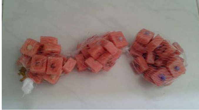
شكل (19) : وضع عينات البحث ضمن كيس مثقب قبل تعريضها للدورات الحرارية
