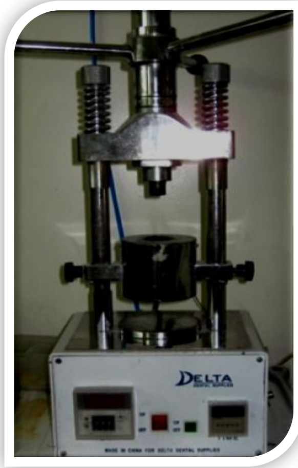
شكل ( 2-2 ) الجهاز الخاص بتسخين وحقن مادة Flexite
