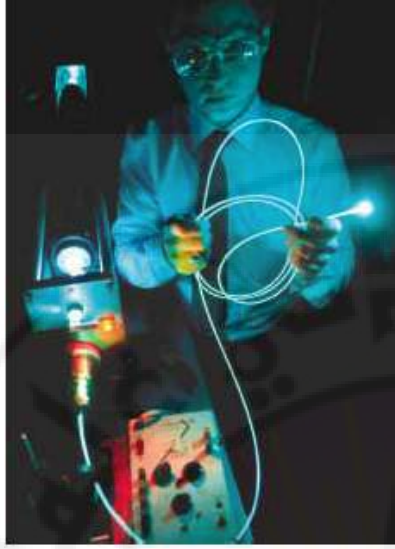
الشكل (3.2): استخدام الألياف الضوئية في نقل الطاقة الضوئية عبر الليف الضوئي (يسار) وجزء من الليف الضوئي يوضح فيه سير الشعاع الضوئي (يمين).
