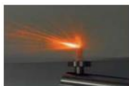
الرأس الخاص بالسطوح الملاصقة ذو نهاية موشورية قادر على حرف أشعة الليزر 100 درجة
