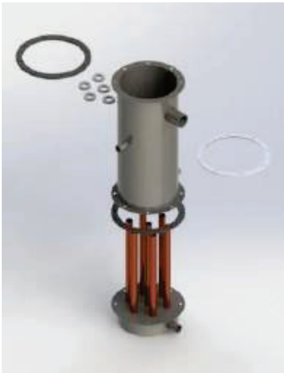
الشكل (2-13) منظور الخزان الحراري المستخدم.
