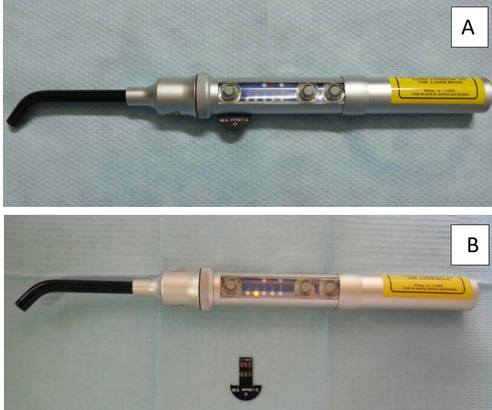
الشكل (17): A - جهاز الليزر بكامل أجزائه، B - جهاز الليزر بعد إزالة رقاقة الأمان
