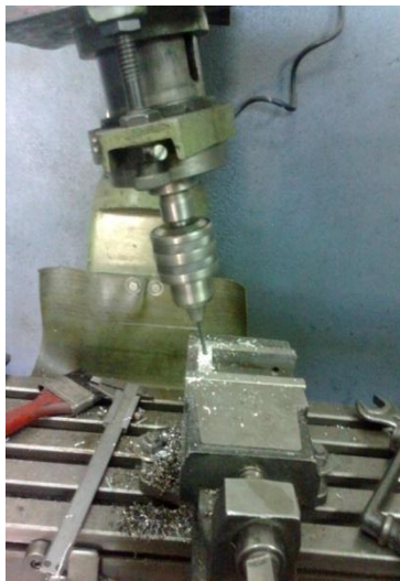
الشكل (2-19) و الشكل (2-20) يظهران طريقة حفر مكان مثيل الغرسة ضمن المكعب المصنوع من الألمنيوم
