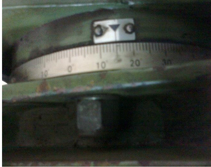
الشكل (2-18) يظهر طريقة تحديد الزاوية المطلوبة على رأس الفارزة
