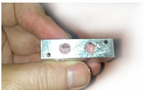
الأشكال (23-2) و (24-2) تظهر تثبيت الغطاء المعدني على الدعامات الكروية للتثبيت ضمن مكعب الألمنيوم ووضع الإكريل
