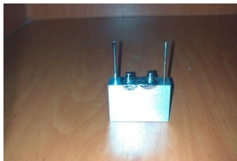
الأشكال (23-2) و (24-2) تظهر تثبيت الغطاء المعدني على الدعامات الكروية للتثبيت ضمن مكعب الألمنيوم ووضع الإكريل
