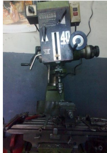
الشكل (2-19) و الشكل (2-20) يظهران طريقة حفر مكان مثيل الغرسة ضمن المكعب المصنوع من الألمنيوم
