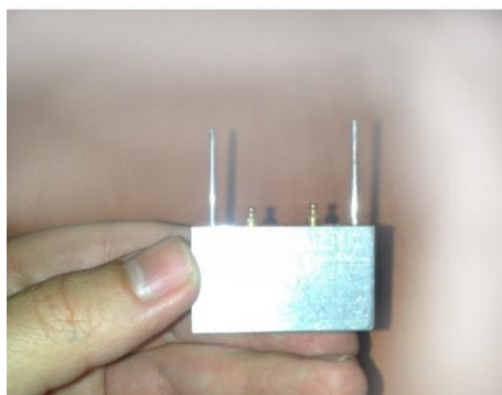
الأشكال (22-2) و (23-2) توضح تركيب الدعامات الكروية و وضع طبقة قصديرية حولها
