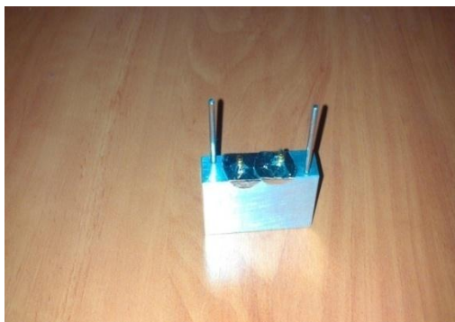
الأشكال (22-2) و (23-2) توضح تركيب الدعامات الكروية و وضع طبقة قصديرية حولها
