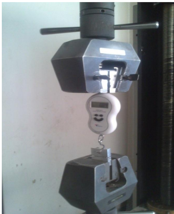
الشكل (2-27) فكا جهاز الـ Instron 1195 مثبتة بها الربيعية و مكعبي الدراسة
