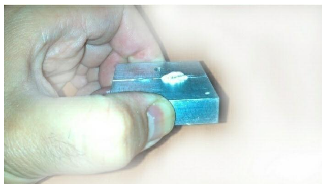
الشكل (25-2) ضغط مكعب الألمنيوم حتى تمام تصلب الإكريل
