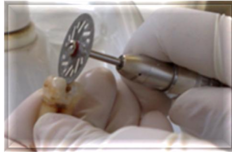
الشكل (2-31): فصل العينة بواسطة القرص الماسي
