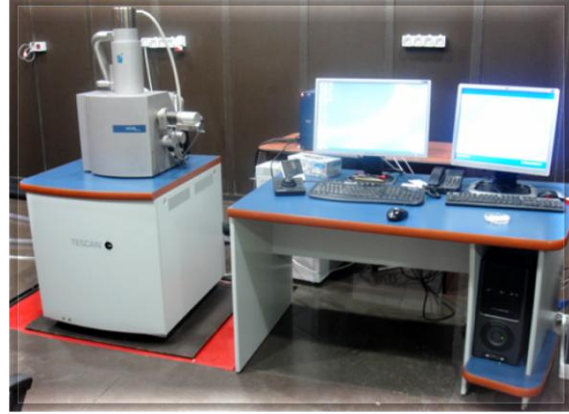
الشكل(2-26): المجهر الالكتروني الماسح SEM ( صورة من داخل حجرة SEM)
