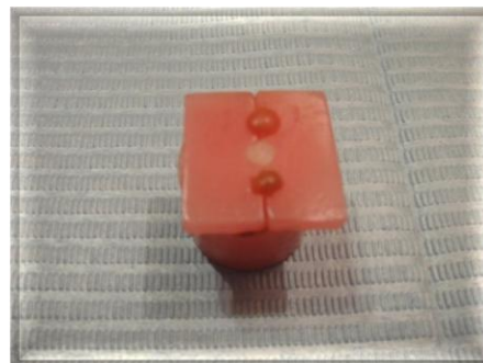
الشكل (2-45): تطبيق الكمبوزيت داخل قالب الاكريل
