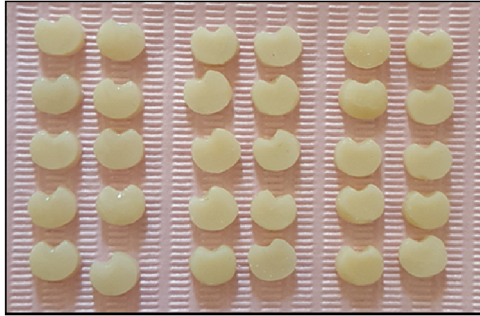
الشكل (50) الأقراص الخزفية المكسورة (مجموعة التجربة)
