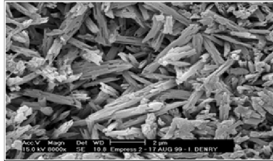
الشكل (2) لبنية المجهرية لخزف IPS Emax Press
