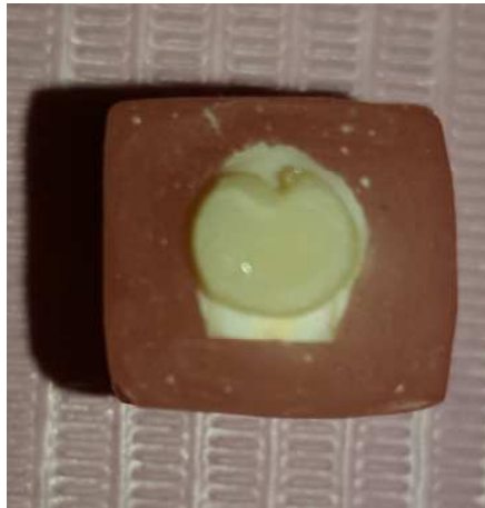
الشكل (66) الكسر الحاصل نتيجة التعرض لاختبار الضغط
