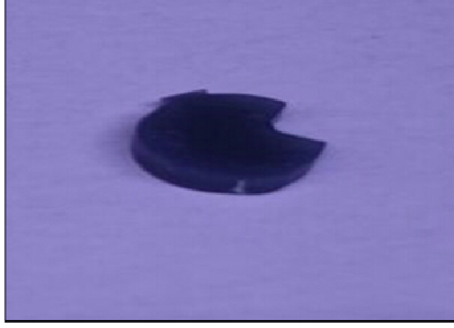
الشكل (42) النموذج الشمعي لقرص مكسور من خزف IPS e.max press
