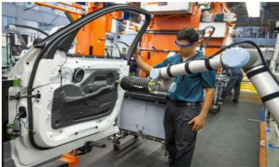
الشكل (4.1): ذراع روبوتية ذات قبضة ثابتة مخصصة لعملية التجميع.
