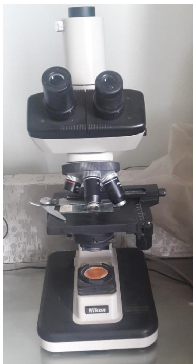
الشكل (62): المجهر المستخدم لفحص عينات التسرب الحفافي
