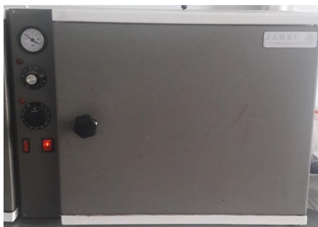
الشكل (37): حاضنة janat من أجل تطبيق الدورات الحرارية على العينات
