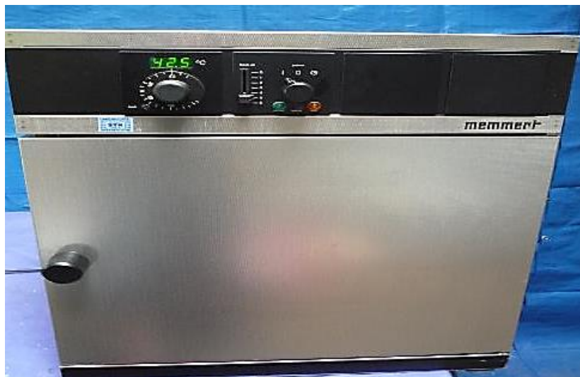
الشكل(36): حاضنة memmert لحفظ الأسنان أثناء فترة البحث المخبري بدرجة 37 مئوية
