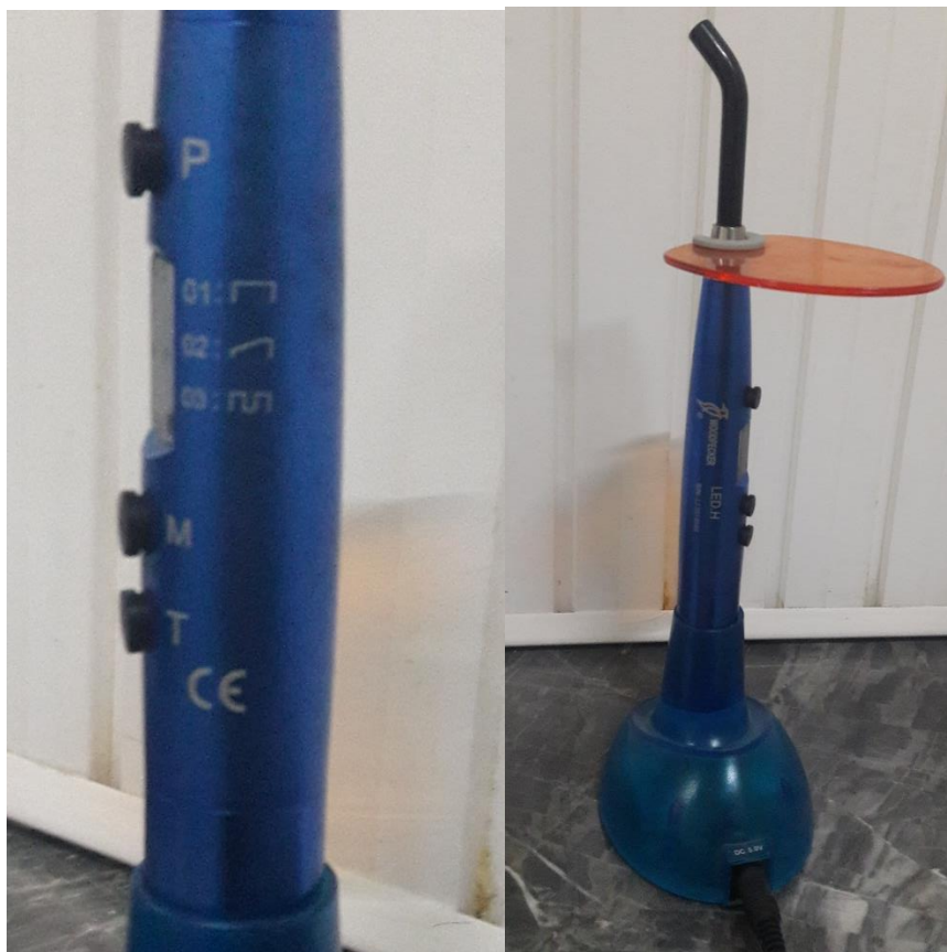
الشكل (34): جهاز التصليب الضوئي المستخدم في البحث Woodpecker وأنماط التصليب المتاحة
