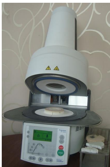
الشكل(35): يوضح فرن المعالجة الحرارية للوجوه المستخدم في البحث
