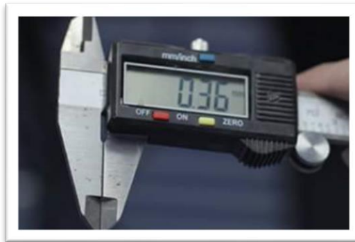
الشكل (20): أداة القياس رقمية Digital Caliper ذات نهايات دقيقة Fine Tips
