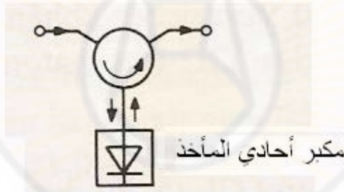
الشكل ( 9 - 11 ) الدوار في المكبر أحادي المأخذ
