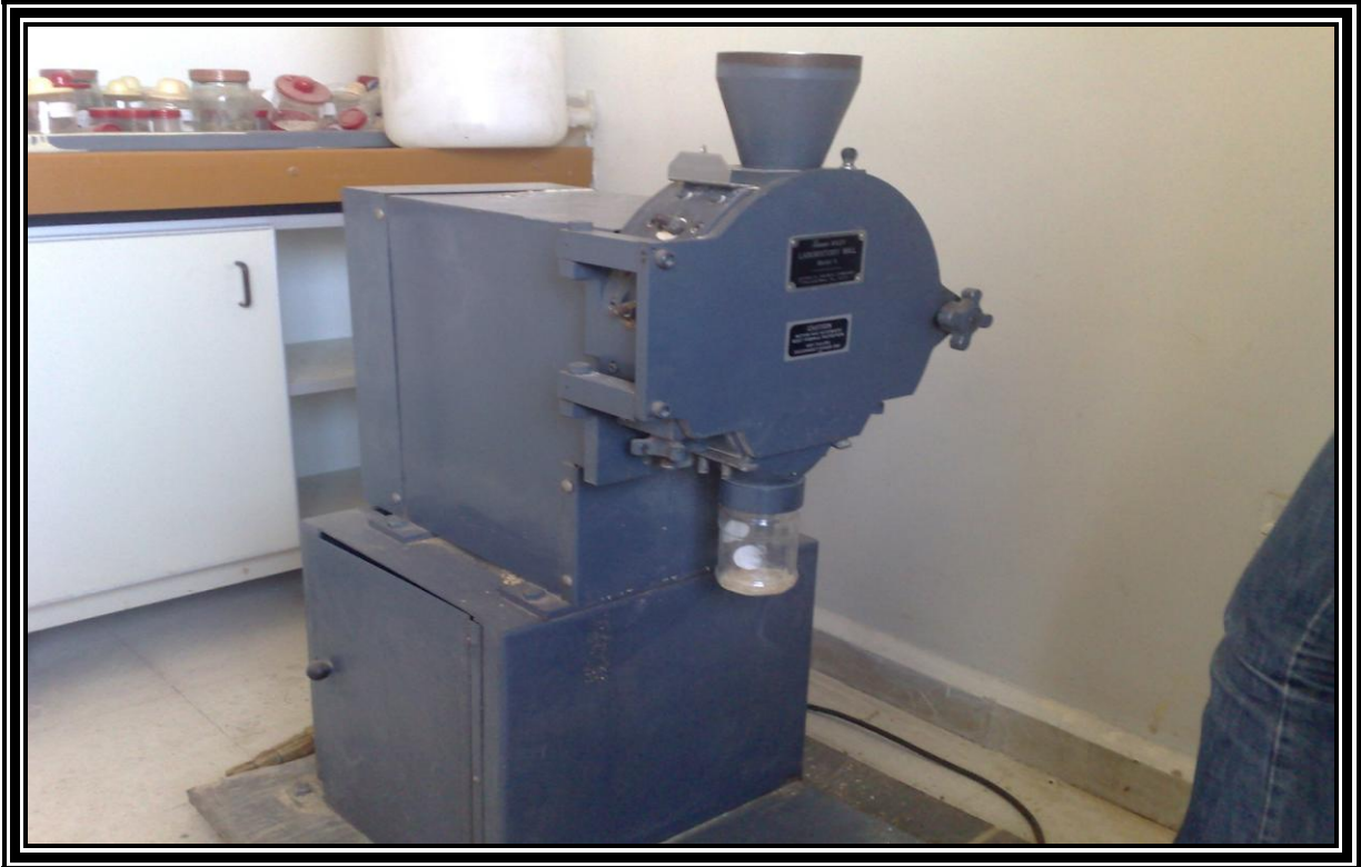
صورة رقم (4) : مطحنة مخبرية طراز TR.C.20
