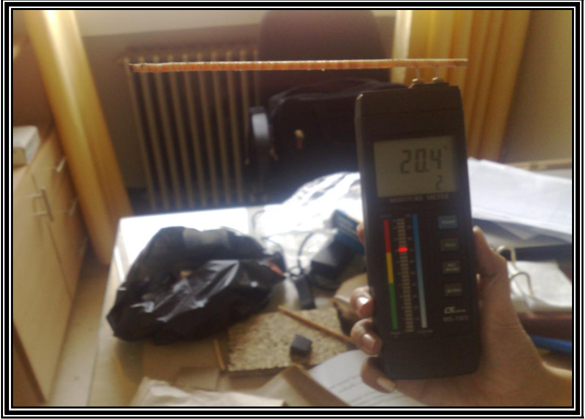
صورة رقم (3) : قياس رطوبة السبرات بمقياس الرطوبة الالكتروني
