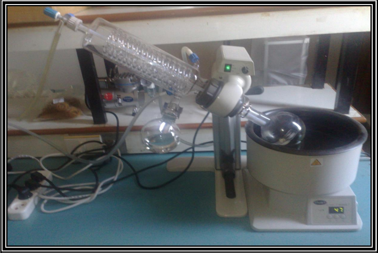
صورة رقم (13): تكثيف المستخلص باستخدام المبخر الدوراني
