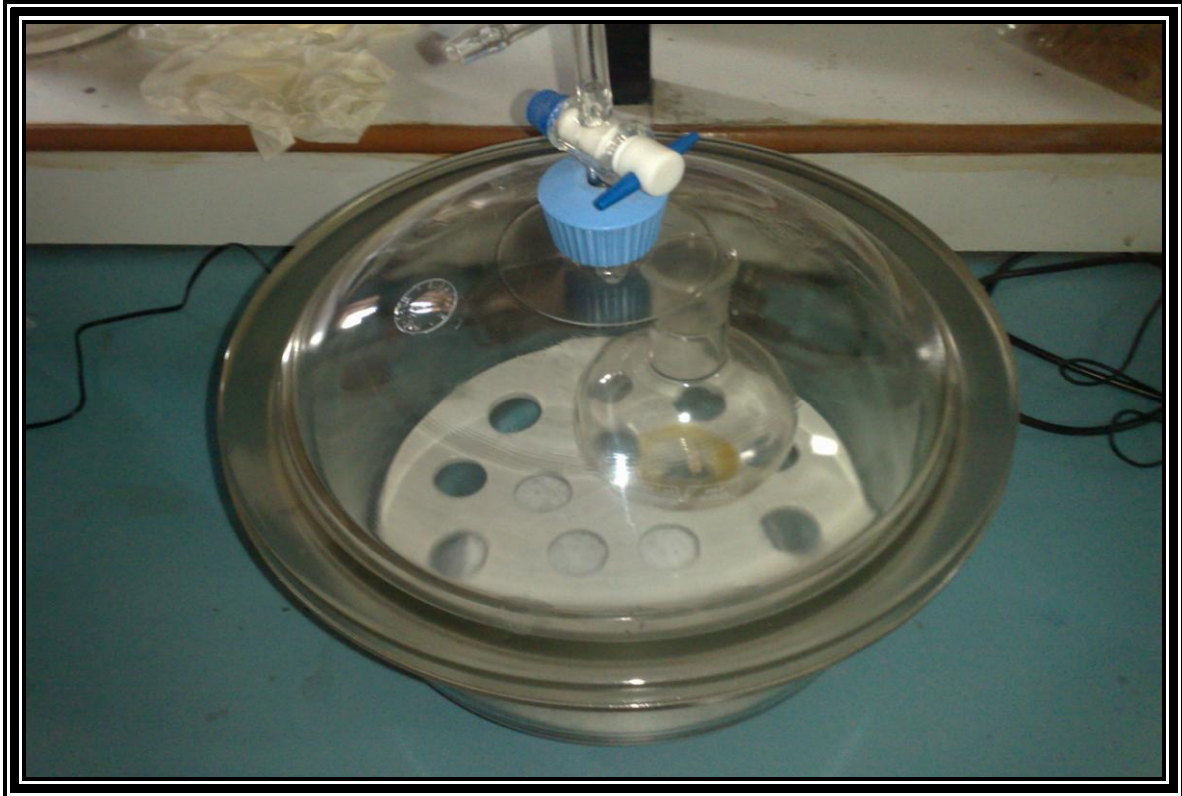
صورة رقم (14): تجفيف المستخلص داخل الحوالة في الديسيكاتور
