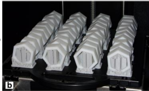
الشكل (2.5.2) يبين العينات الناتجة بعد التصنيع عند درجة حرارة ترسب 270 درجة مئوية [5].
