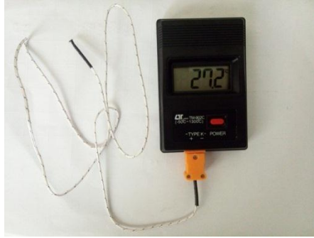
الشكل (27.4) المزوجة الحرارية.
