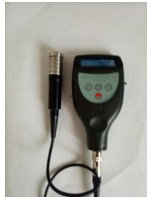
الشكل (44.4) جهاز الخشونة .
