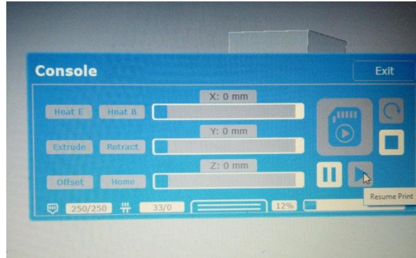
الشكل (30.4) معايرة الحرارة برنامج console.
