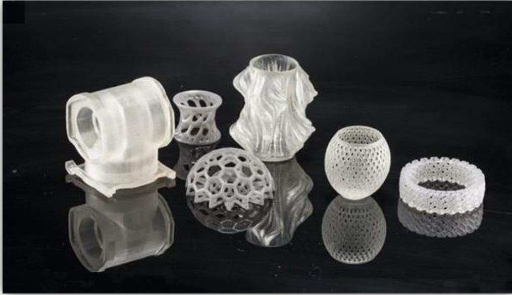
الشكل (1-4) يوضح نماذج تم إنتاجها بتقانة (SLA) [10]
