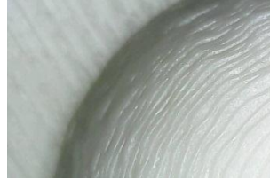
الشكل (48.4) البنية السطحية للكرة سماكة 0.25
