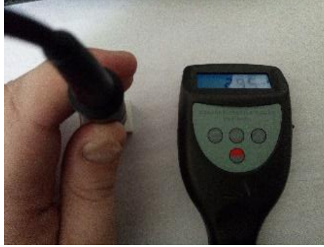
الشكل (47.4) عملية قياس الخشونة.
