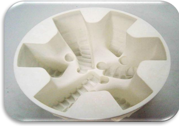
الشكل (8-1) نموذج مصنع بتقانة (LOM) [13].
