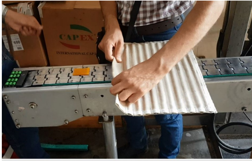
رسم توضيحي 5-11 تجربة اللف بالسجادة الخاصة بلف الكروسان
