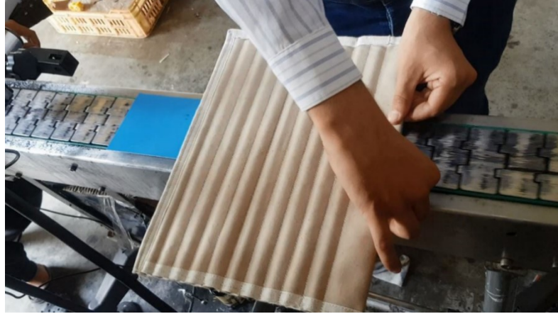
رسم توضيحي 5-7 تجربة قطعة السير المرن في عملية اللف
