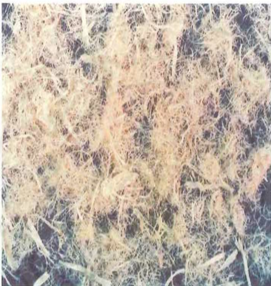
صورة (١٠): ألياف خشبية مفصولة على درجة حرارة ١٦٠ درجة مئوية ( Deppe and Ernst, ١٩٩٦ )
