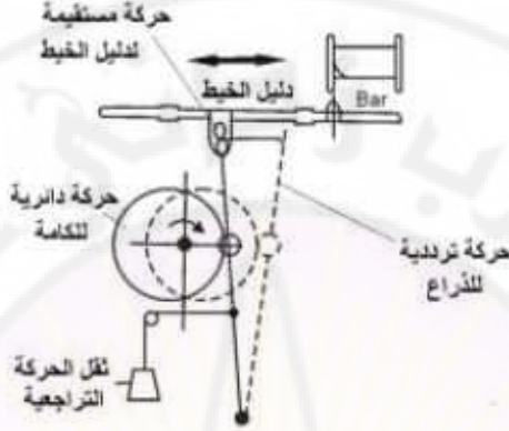
شكل 3-3: حركة ميكانيزمات دليل الخيط
