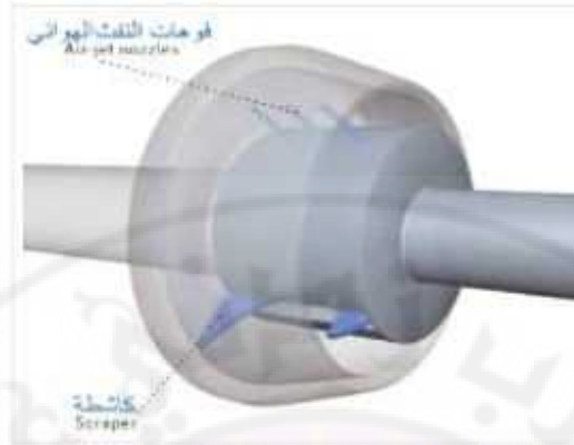
شكل 11-11: نظام مدمج لتنظيف الروتور
