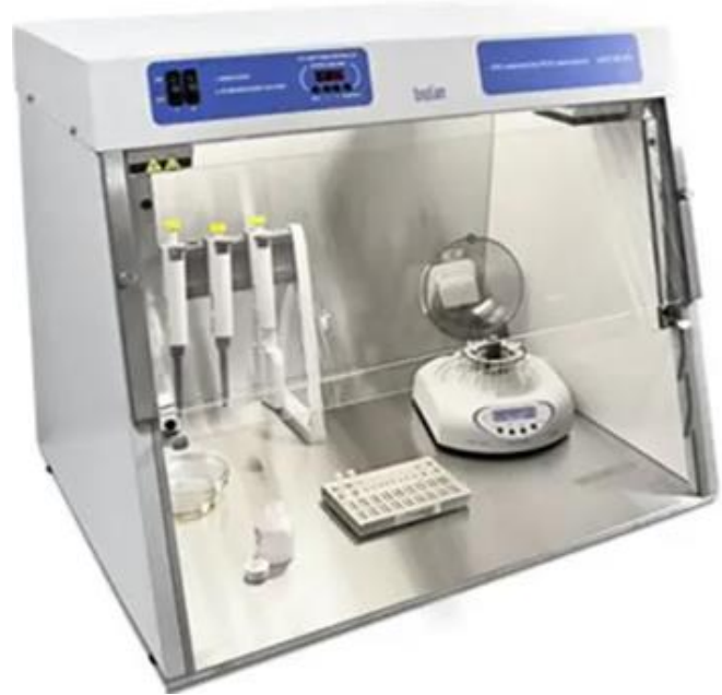
الشكل 18. صورة للحجيرة الخاصة بالتفاعل السلسلي للبوليميراز.
