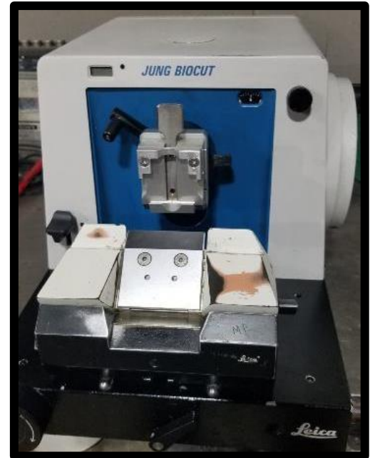
الشكل 12. صورة مشراح (microtome).
