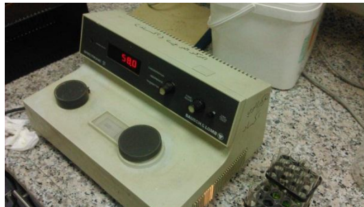
الشكل (37) قياس قيم الامتصاص الضوئي لكل عينة باستخدام مقياس الطيف الضوئي
