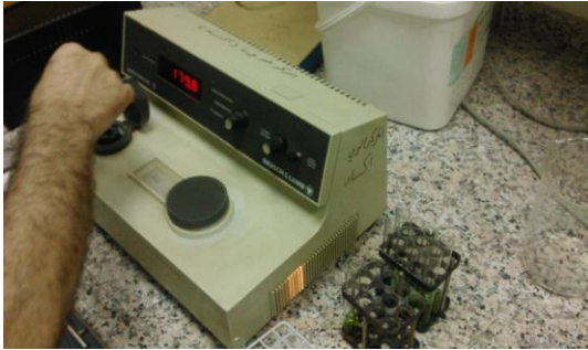
الشكل (31) قياس الامتصاص الضوئي للعينة باستخدام مقياس الطيف الضوئي
