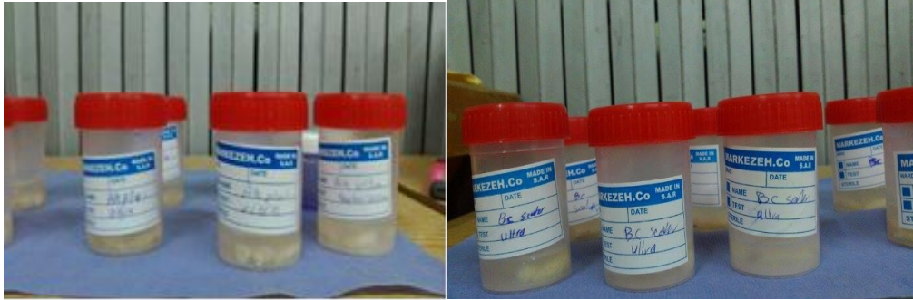
صورة رقم 27: خسف الأملاح المعدنية للعينة بوضعها بحمض كلور الماء 5%.
