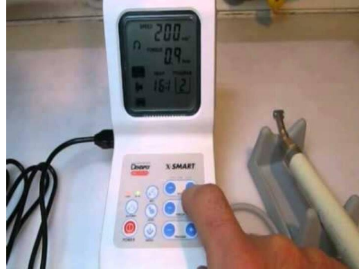
الصورة رقم 5:جهاز X-smart مخصص للأدوات الآلية الدوارة المستخدمة في المعالجة اللبية من شركة
