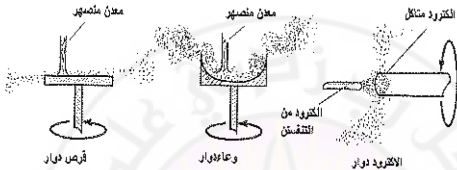
الشكل (١٥-١) التنذير بقوة الطرد المركزي
