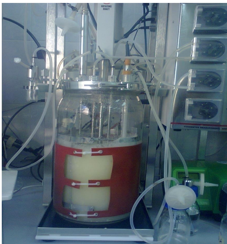
الشكل-14 . خلايا وحدة التخمر التجريبية (electrolab)
