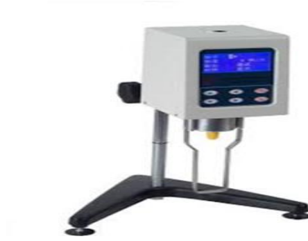
الشكل (2-8) يوضح جهاز الرايوميتير.
