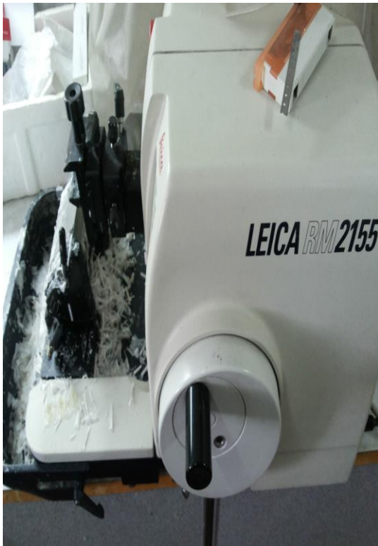
صورة 2- : المباشرة النسيجية Microtome (LEICA RM ،ألمانيا) و المحم المستخدم
