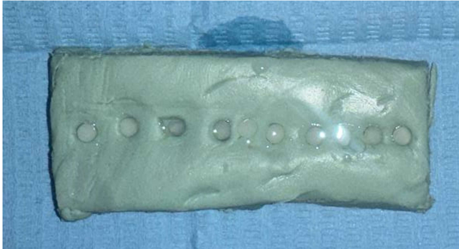
الشكل (36): تطبيق عامل مزوجة الخزف (Silane) للأقراص الخزفية في المجموعة الثانية.
