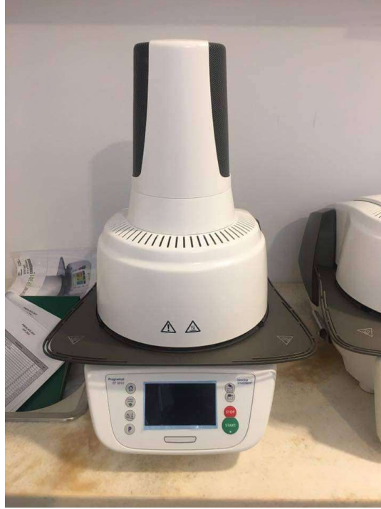
الشكل (5): فرن حقن الأقراص الخزفية (Programat EP 3010).
