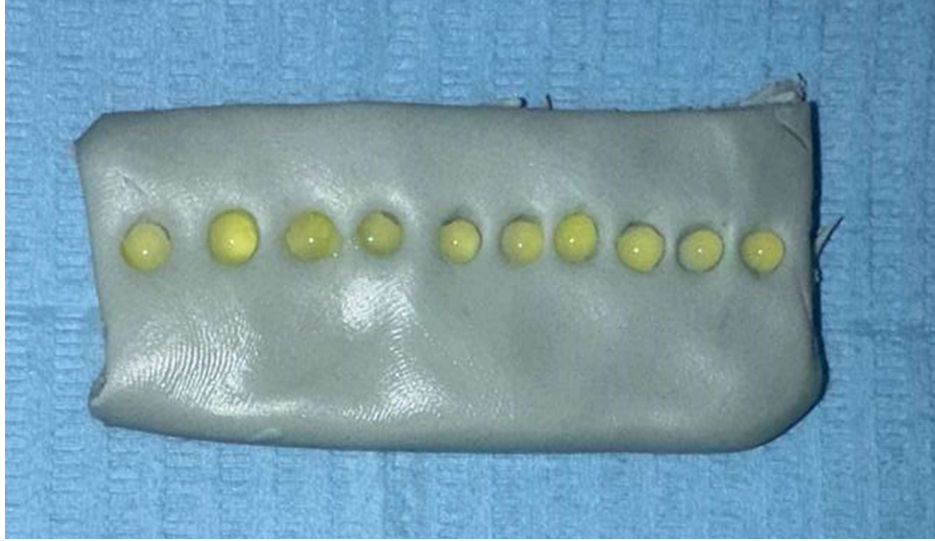
الشكل (25): تخريش الأقراص الخزفية في المجموعة الأولى بحمض فلور الماء 9.5%.
