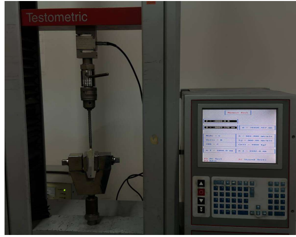
الشكل (67): اختبار مقاومة قوى القص باستخدام جهاز (Testometric).
