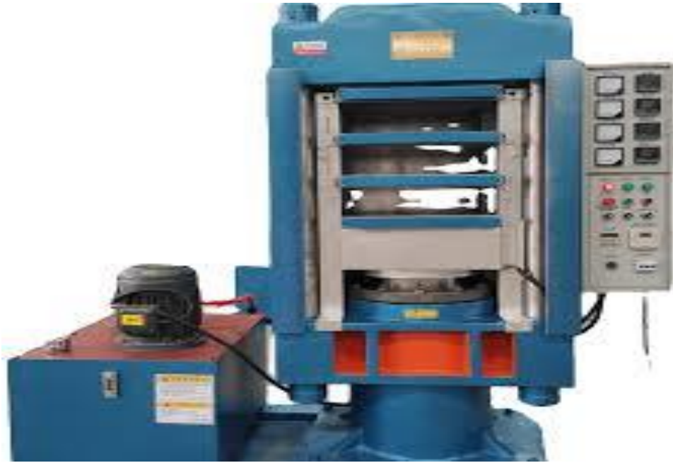
الشكل (4-15) المكبس الهيدروليكي
