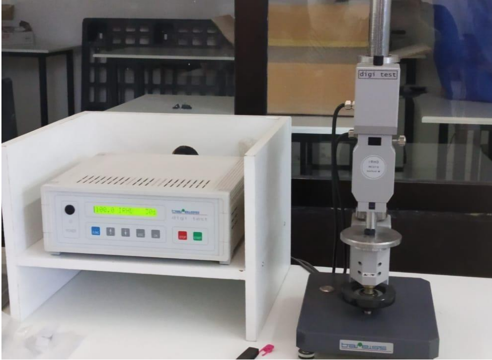
الشكل (4-21) جهاز القساوة المستخدم
