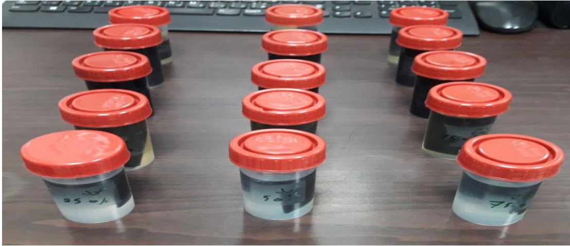
الشكل (4-25) العينات مغمورة ضمن سائل الاختبار
