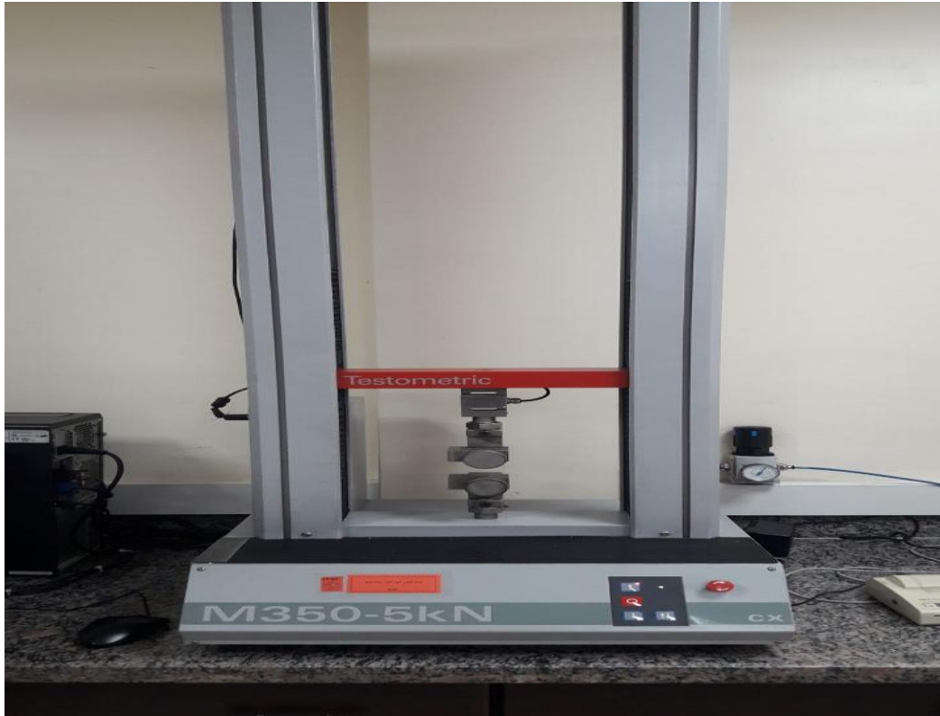
الشكل (4-19) جهاز اختبار الشد
