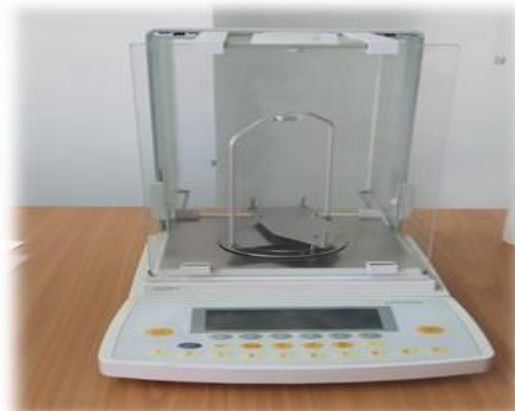
الشكل (4-23) جهاز اختبار الكثافة
