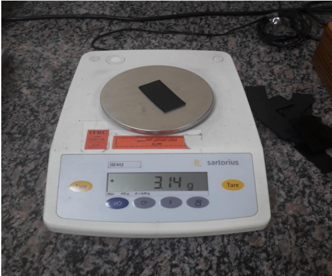
الشكل (4-26) وزن عينات اختبار الانتباجية بعد الغمر
