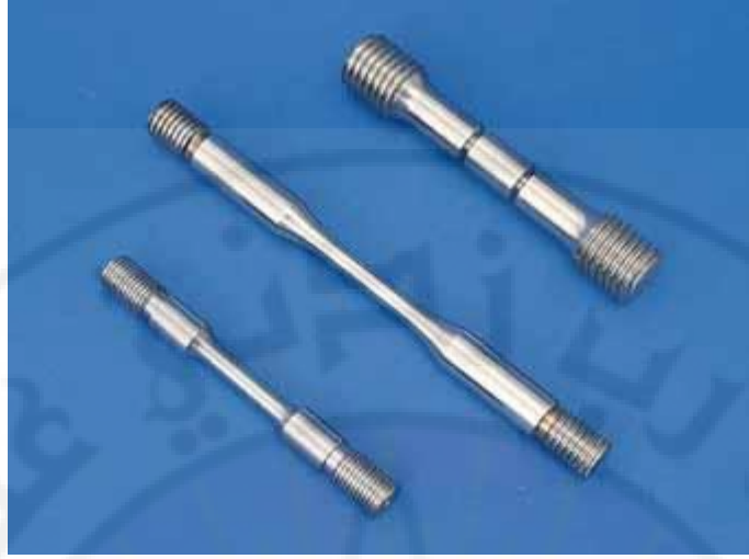
الشكل (5) أشكال عينات الشد الاسطوانية
